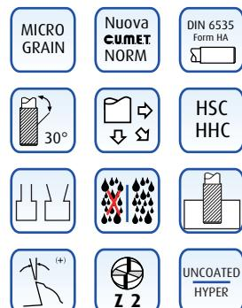
Tutte le nostre frese standard vengono costruite con lo stesso procedimento delle frese ad alto rendimento: tolleranza del diametro di taglio h8, ottime finiture dei taglienti, controllo costante delle geometrie con sistemi ottici automatici.
