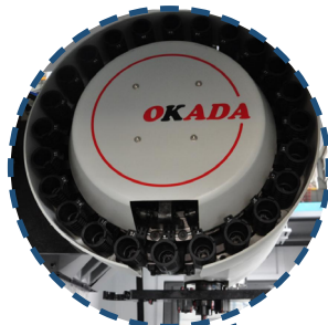
Автоматическая смена инструмента (24 позиции)
