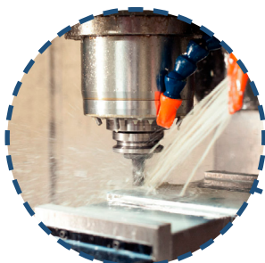
Система подачи СОЖ через шпиндель (30 бар)
