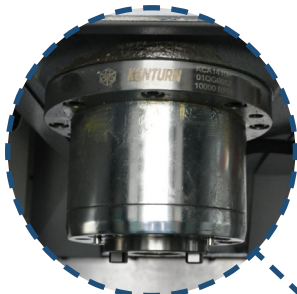
Шпиндель BT40 (11/15 кВт, 12000 об/мин)
