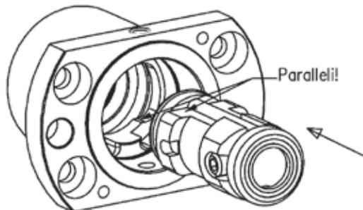
2— Drehen Sie den HN63C-Spannzylinder nun um 90°, sodaB die kleine Einfräsung auf der Seite des Spannzylinder sich unter dem Gewindestift befindet, der im Einsatz sitzt. Die Bohrung am Flansch und die Spanschraube am Spannzylinder sind nun in einer Linie.
