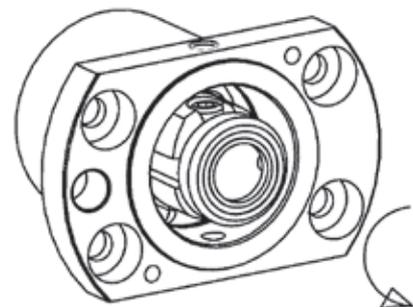
3— Schrauben Sie den M5x12 Gewindestift fest ein, sodaB der HN63C-Spannzylinder festgehalten wird.
