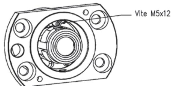
4— Zur Montage und Demontage der HSK63A-Werkzeuge, schrauben Sie mit dem 5mm-Inbusschlüssel im Uhrzeiger- und Gegenuhrzeigersinn die Klemmschraube auf den HN63C-Spannzylinder auf und zu.
