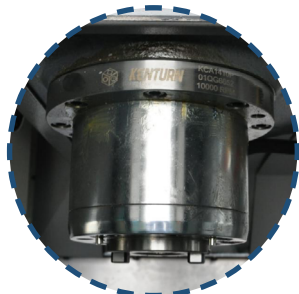
Шпиндель BT40 (11/15 кВт, 12000 об/мин)
