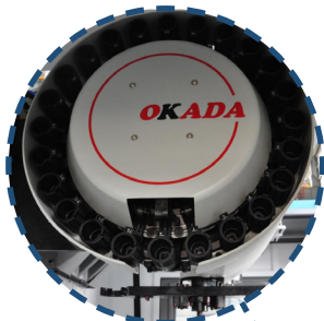
Автоматическая смена инструмента (24 позиции)
