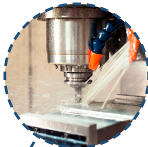
Система подачи СОЖ через шпиндель (30 бар)
